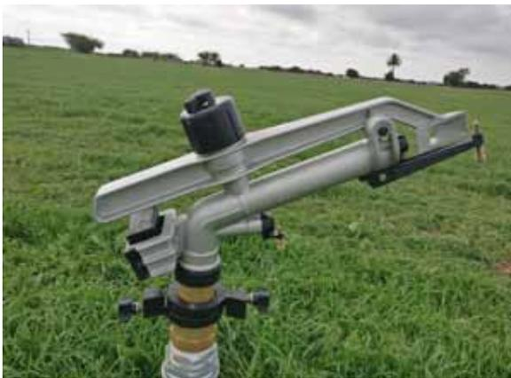
**Figura N° 27.** a, b) Cañón fijo para aplicación de efluente a terreno. c) Aplicación de efluente a terreno con cañón fijo.
